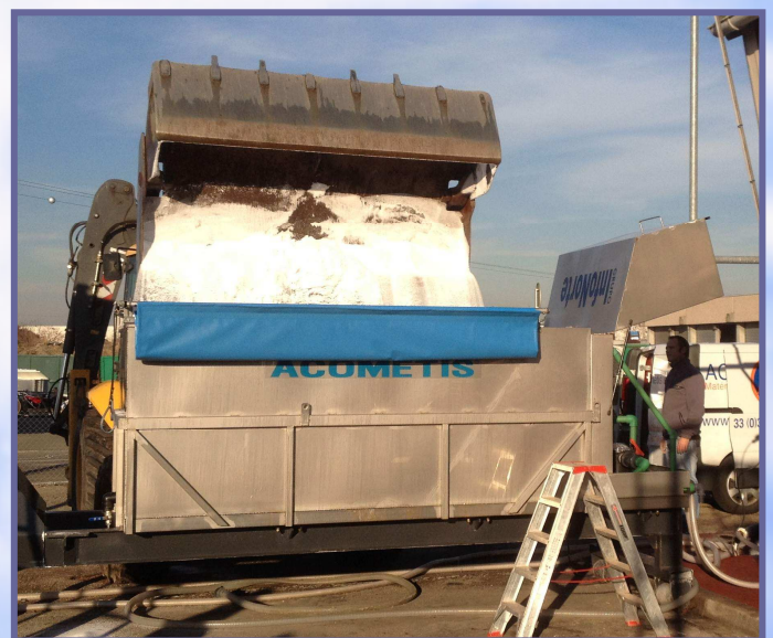
Chargement de sel fin dans une installation à courant ascendant
